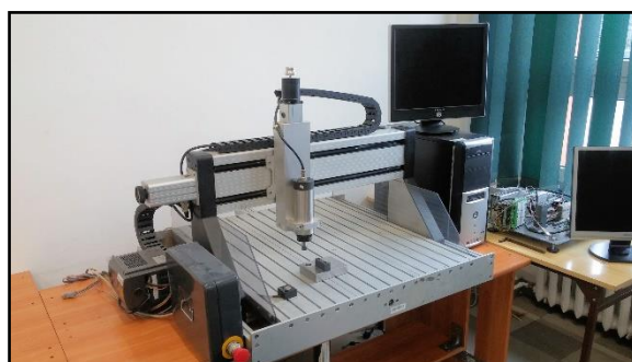
Rys. Modernizacja frezarki CNC – sterowanie Linux CNC
