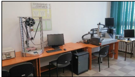
Rys. Drukarka 3d o konstrukcji Delta skonstruowana o zbudowana w ramach Koła naukowego
